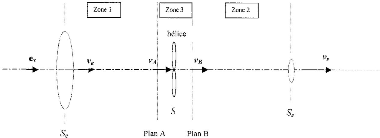
2.1. En appliquant la conservation du débit massique, établir les relations qui relient les vitesses  $v_A$ ,  $v_B$ ,  $v_e$ ,  $v_s$  et les trois sections  $S$ ,  $S_e$  et  $S_s$ .
