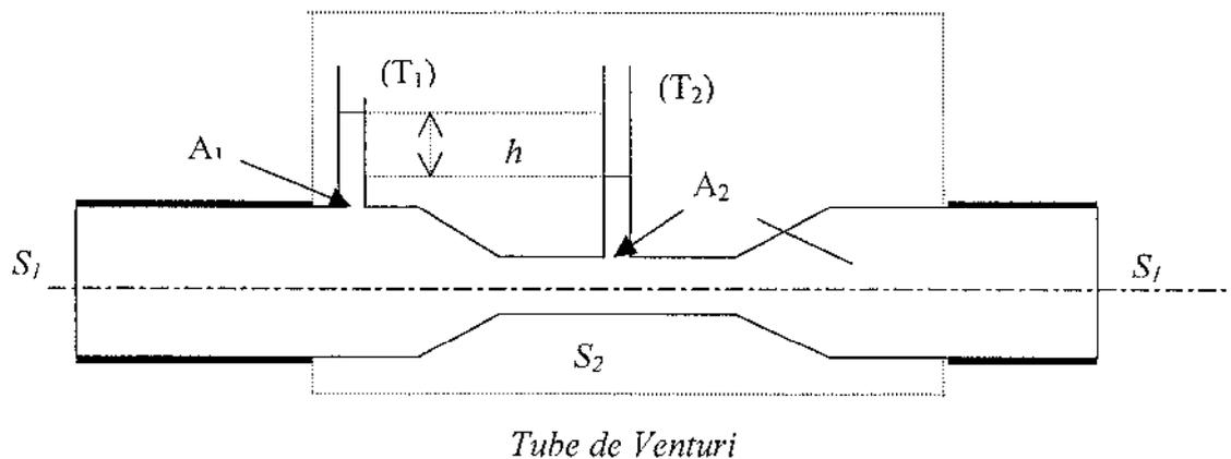
On note  $P_0$  la pression atmosphérique,  $P_1$  la pression et  $v_1$  la vitesse de l'écoulement en amont du tube de Venturi.  $A_1$  est un point à la base du tube ( $T_1$ ) et  $A_2$  est un point à la base du tube ( $T_2$ ).
