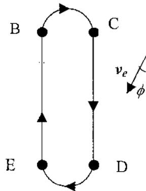
Le pilote adapte l'inclinaison de l'appareil et donc le rayon des tronçons semi-circulaires BC et DE de manière à ce que ceux-ci durent 1 minute chacun. Durant cette attente, la vitesse  $V$  de l'avion est supposée constante et égale à  $222 \text{ km.h}^{-1}$ , tandis que la vitesse du vent est toujours  $v_e = 56 \text{ km.h}^{-1}$ , et  $\phi = 20^\circ$ .
